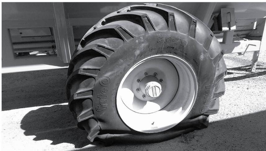
жесткая и не способна так же амортизировать удары, как пневматическая. Как следствие: увеличиваются ударные нагрузки на механизмы и груз, ухудшаются условия труда оператора, снижается безопасность. Из-за особенностей изготовления доступны только самые распространенные типоразмеры цельнолитых колес, в основном небольших диаметров. Эксплуатационные проблемы отчасти могут решить специальные полые литые колеса премиум-класса с эластичными спицами, но они дороги и пока редко встречаются на рынке.
